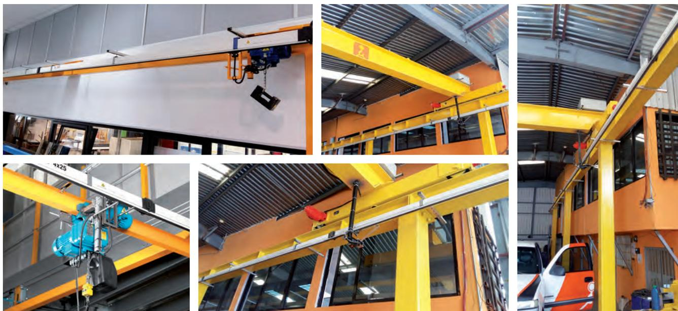
Para decidir el tipo de línea, adecuado por intensidad y para determinar la situación de la/s alimentación/es de la línea, se considerará la suma de intensidades de motores que puedan actuar simultáneamente, así como la previsible caída de tensión.
