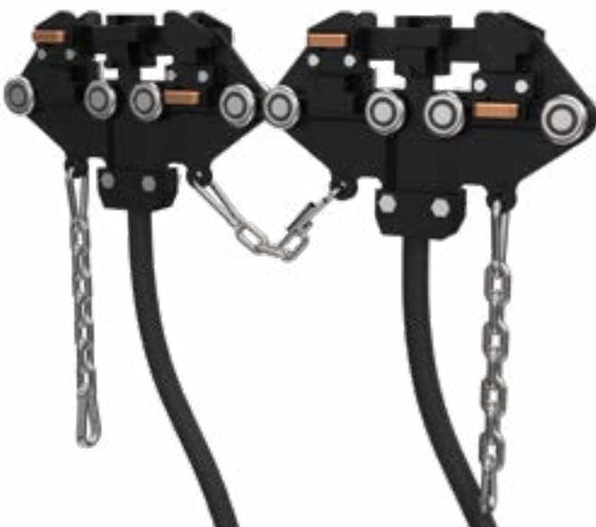
Necesario para intensidades entre 35 A. y 70 A. También es preciso montar carro doble en instalaciones que requieran seccionador de corriente ref. RG12. Formado por la unión, a cadena, de dos carros colectores ref. RG14.
