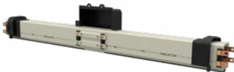
Se utiliza para interrumpir a voluntad el paso de corriente eléctrica en una sección determinada de la línea. Para este tipo de instalaciones es preciso utilizar carros dobles. Puede ser montado y conectado entre dos barras modulares. Se suministra dispuesto para su conexión a las barras modulares.
