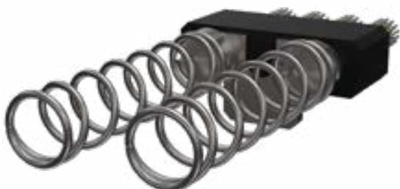
Fabricadas en nylon de 0,5mm, limpian los conductores del polvo de cobre. Ejercen presión sobre éstos mediante muelles de acero inoxidable. Es un elemento de reposición ya que trabaja sometido a desgaste.
