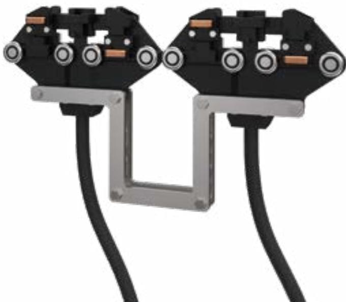
Cuerpo en material aislante y 4 escobillas en metal-grafito N-51 con muelles inox.302. Se desplaza mediante rodamientos metálicos a bolas.
